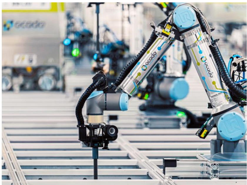
KI-gesteuert: Zur Automatisierungstechnik von Ocado gehören auch Pick-Roboter.
